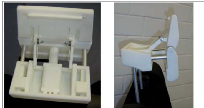
Abb. 6.9: Draufsicht der ausgelösten Kopfstütze
